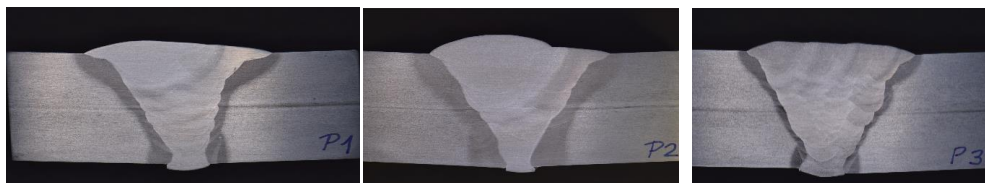
4. ábra: A P1, P2, P3 jelű próbatestek makrociszolatjai
