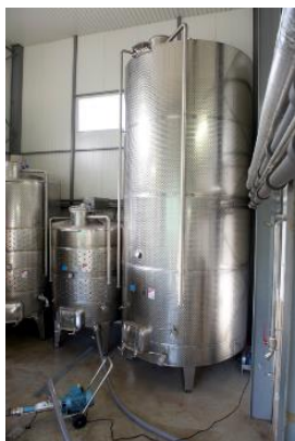
8. ábra: Saválló erjesztőtartály
