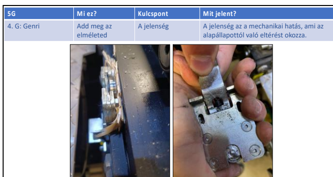
9. ábra: 4. G – az eltömődött, olajos középkapcsoló Forrás: saját szerkesztés
