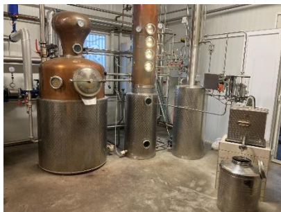
11. ábra: KOTHE K 1000N nagy teljesítményű pálinkafőző berendezés
