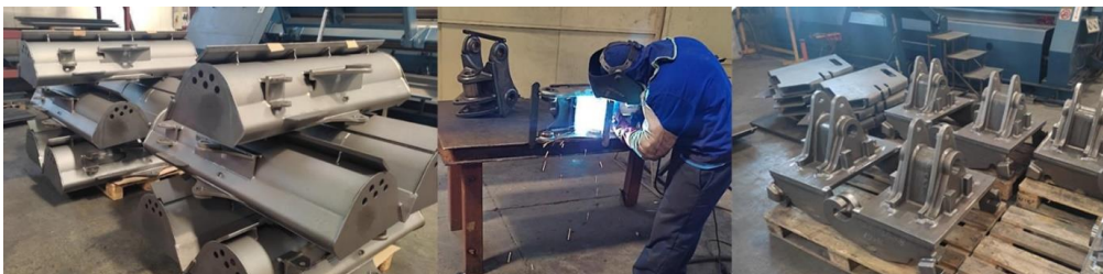
8. ábra: TDA-kanál, SM-pivot és SFC-pivot Forrás: saját fénykép
