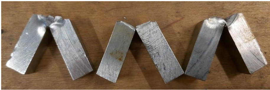
9. ábra: Eltört ütőpróbatestek (balról: P1, P2, P3) Forrás: saját fénykép
