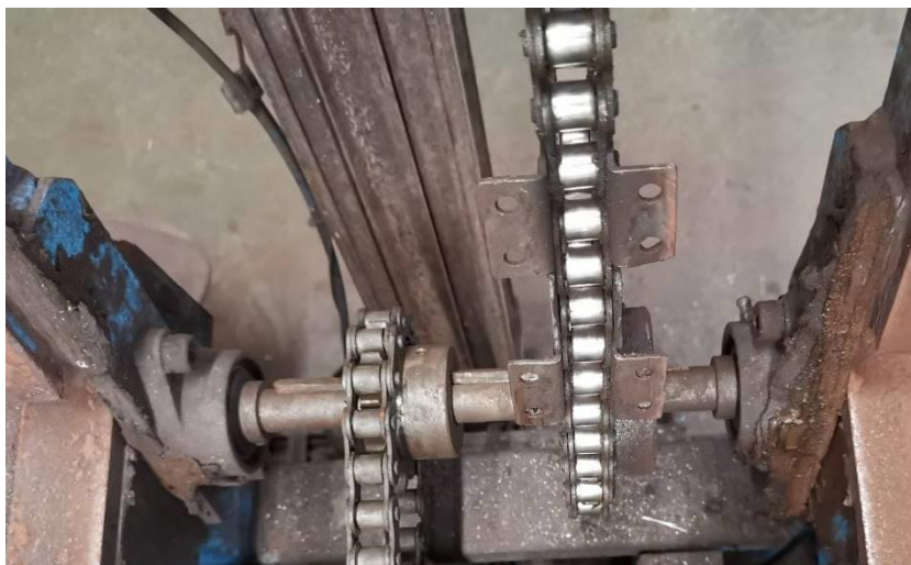
1. ábra: A jelenlegi konstrukció hajtótengelye
