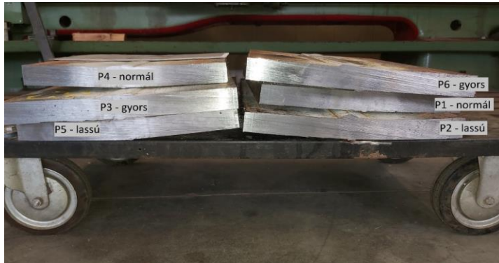
2. ábra: A kész munkapróbák szögzsugorodása Forrás: saját fénykép
