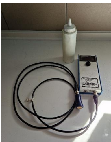
1. ábra: Ultrahangos hátszalonnavastagság-mérő műszer és az ultrahangzselé Forrás: Bozó D.
