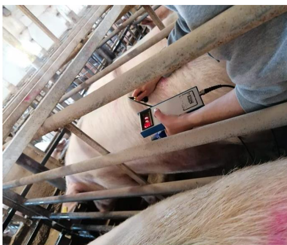
2. ábra: Hátszalonna-vastagság mérése P2-nél ultrahangos mérőműszerrel Forrás: Bozó D.
