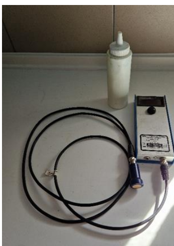
1. ábra: Ultrahangos hátszalonnavastagság-mérő műszer és az ultrahangzselé Forrás: Bozó D.
