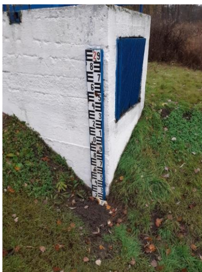
1. ábra: Vízmérce (Forrás: Szarka Márton, saját fotó)
